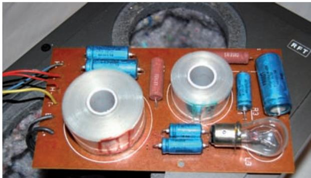
**Abb 4:** Frequenzweiche der BR-26 mit Folienspulen, Elektrolytkondensatoren und Kaltleiter zum Schutz des Hochtöners
