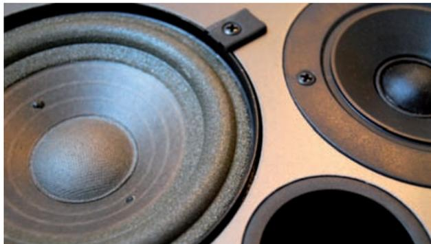
**Abb 3:** Nahaufnahme einer erneuerten Schaumstoffsicke, der altersbedingt häufigsten Fehlerquelle
