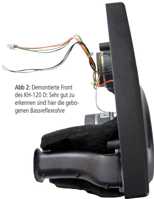
Abb 2: Demontierte Front des KH-120 D: Sehr gut zu erkennen sind hier die gebogenen Bassreflexrohre
