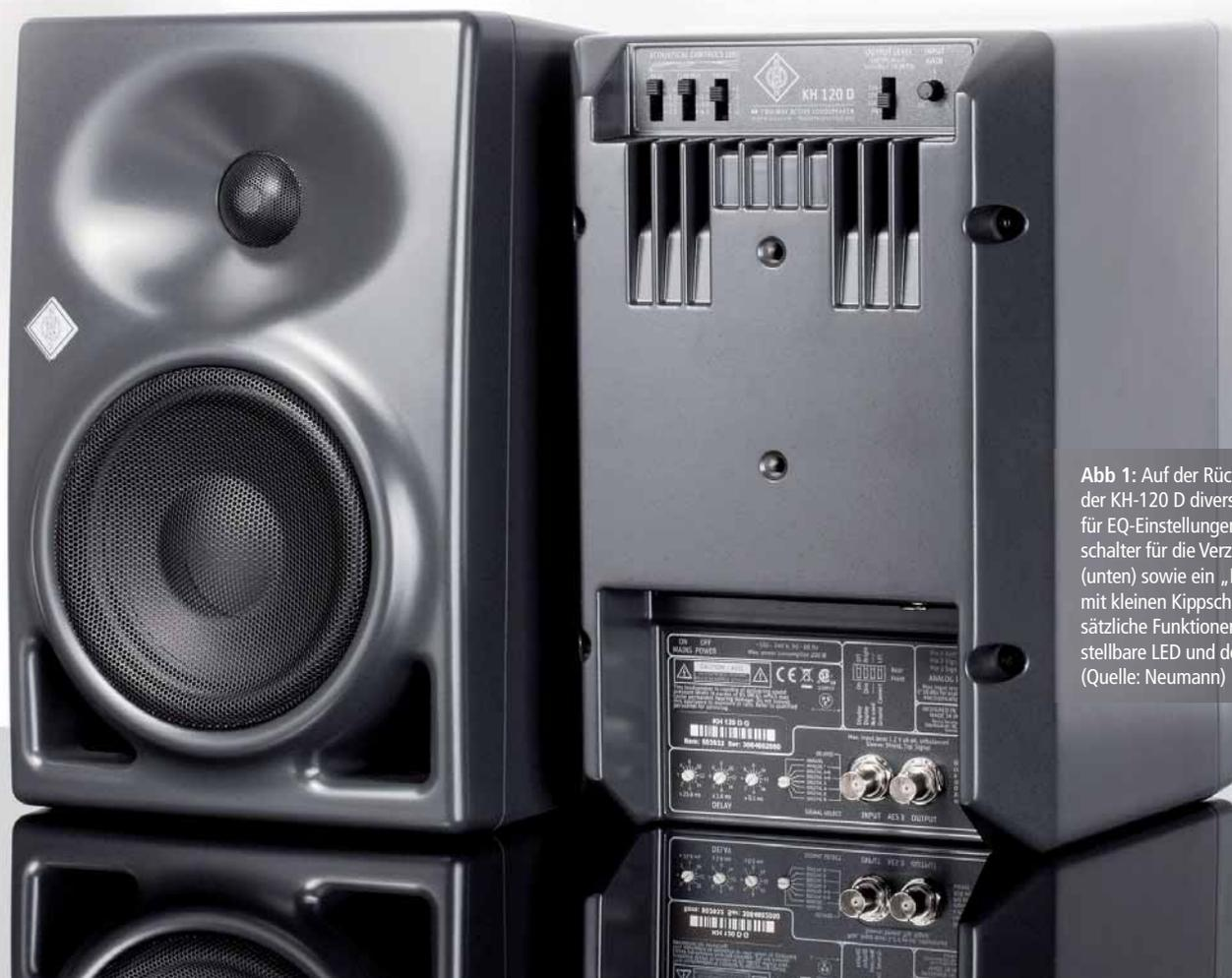
Abb 1: Auf der Rückseite bietet der KH-120 D diverse Stellschalter für EQ-Einstellungen (oben), Dreh- schalter für die Verzögerung (unten) sowie ein „Mäuseklavier“ mit kleinen Kippschaltern für zusätzliche Funktionen wie die einstellbare LED und den Ground Lift (Quelle: Neumann)
