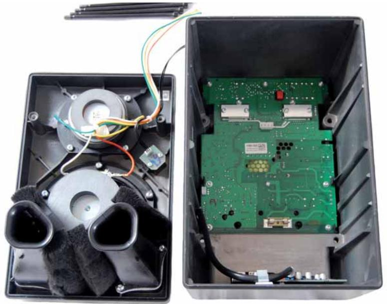
Abb 3: Freie Sicht in das geöffnete Gehäuse (für das Foto wurde ein großer Teil Dämpfungsmaterial entfernt): Zusammengehalten werden die beiden Gehäuseteile über vier sehr lange Spezialschrauben, wobei sie per Nut und Feder luftdicht abschließend aneinander gepresst werden
