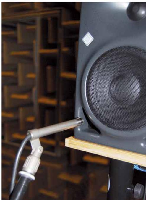
Abb 5: Nahfeldmessung direkt an der Bassreflexöffnung (Messmikrofon Microtech Gefell MK-201 mit Impedanzwandler MV-203)
