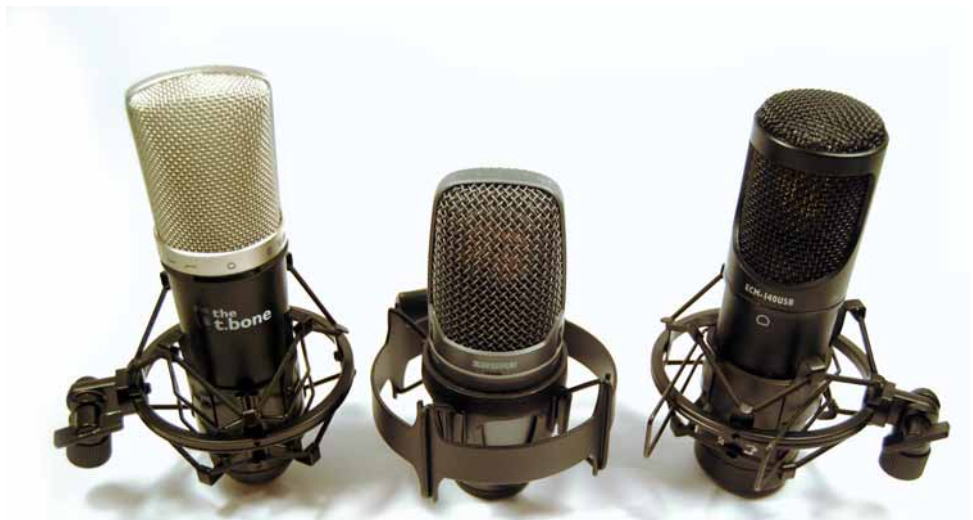
Eine klassische Spinne eines Gesangsmikrofons, welche die Übertragung von unerwünschtem Körperschall auf die Membran verringert, befindet sich bei den Mikrofonen von t.bone, Shure sowie IMG Stage Line im Lieferumfang
