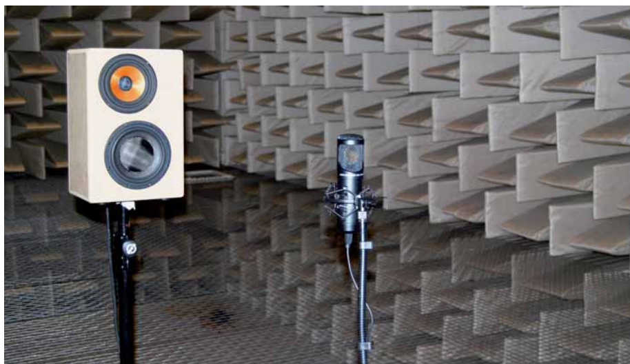
Messungen im reflexionsarmen Raum, wo die Mikrofone von einem speziellen Lautsprecher beschallt und sowohl in 1 m und 0,1 m Entfernung für die Ermittlung der Frequenzgänge gemessen werden – ein ferngesteuerter Drehteller rotiert die Mikrofone, um so das Richtverhalten (in der Folge in Form von Isobaren dargestellt) zu messen.
