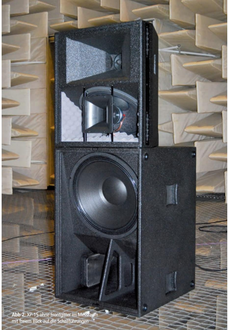
Abb 2: XP-15 ohne Frontgitter im Messraum mit freiem Blick auf die Schallführungen
