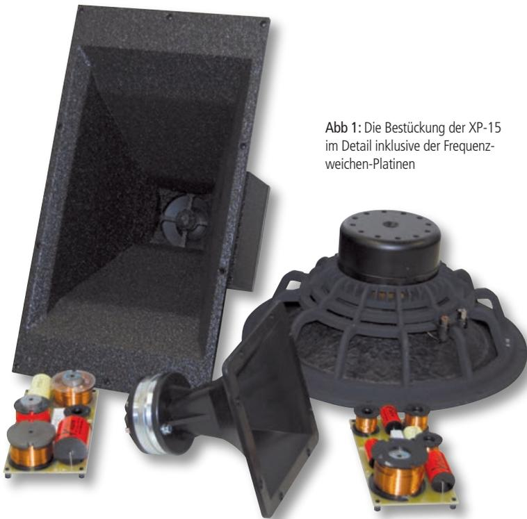
Abb 1: Die Bestückung der XP-15 im Detail inklusive der Frequenzweichen-Platinen
