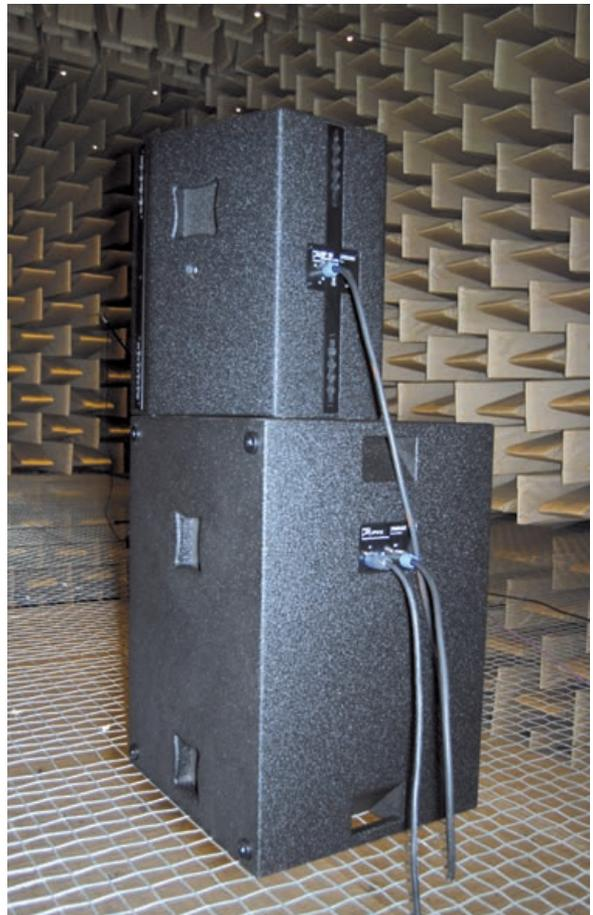
Abb 3: Rückseite eines Stacks mit XP-15 und XPW-18, hier sind die gefrästen Griffe und die über die volle Gehäusehöhe laufenden Flugschienen zu erkennen – die Systemverkabelung findet mit 4-poligen Speakon-Verbindungen statt
