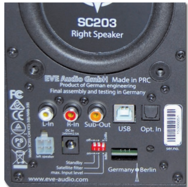
Abb 2: Anschlussseite des Master-Lautsprechers mit Blick auf Buchsen und Passivmembran (oben angeschnitten)
